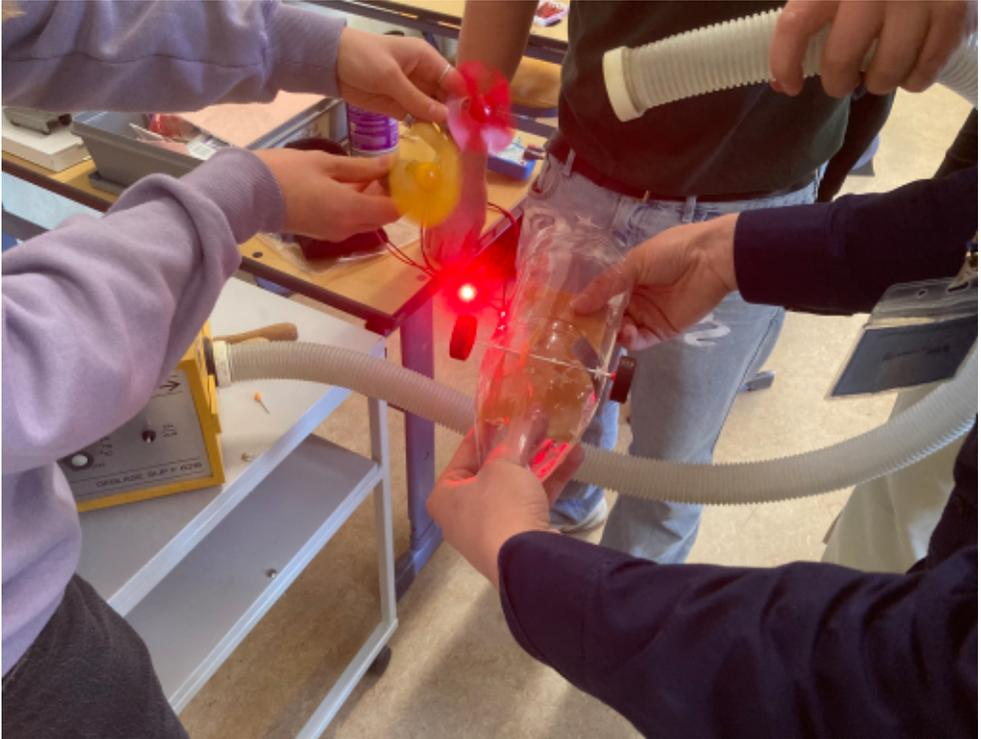
*Es wird windig - die Gebläse betreibt die Windgeneratoren und Strom fließt (Lämpchen leuchtet), um dann die Räder anzutreiben.*
