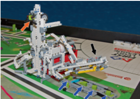
Unser Roboter erfüllt sportliche Aufgaben: Gewichtheben (grüner Pfeil), Reifen drehen (roter Pfeil), Würfel-"Zielwurf" (blaue Pfeile) aus dem Arm (schwarzer Pfeil) und Anschubsen beim Rutschen (gelber Ring).
