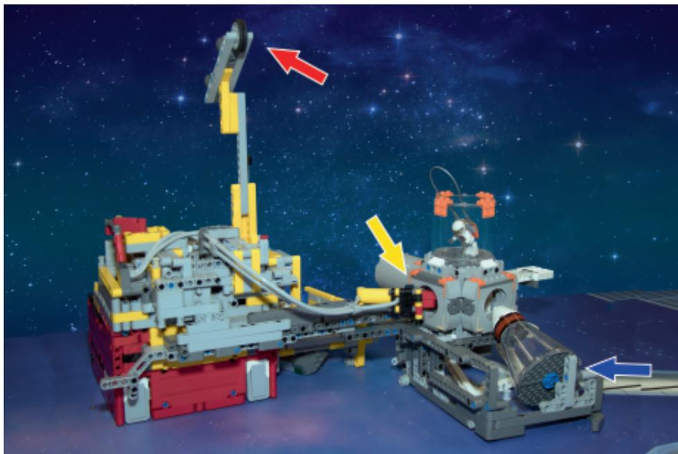
*Unser Roboter mit dem Modul 2, Version Semi Final: Die Räder, die das Raumschiff in den Orbit schießen, sind durch einen mit zwei Stahlkugeln beschwerten Hammer ersetzt (roter Pfeil). Das Kegelmodul wird nicht mehr aus der Raumstation gezogen, sondern pneumatisch aus dem Rumpf gedrückt (gelb) und in einem Transportkorb aufgefangen (blau).*
